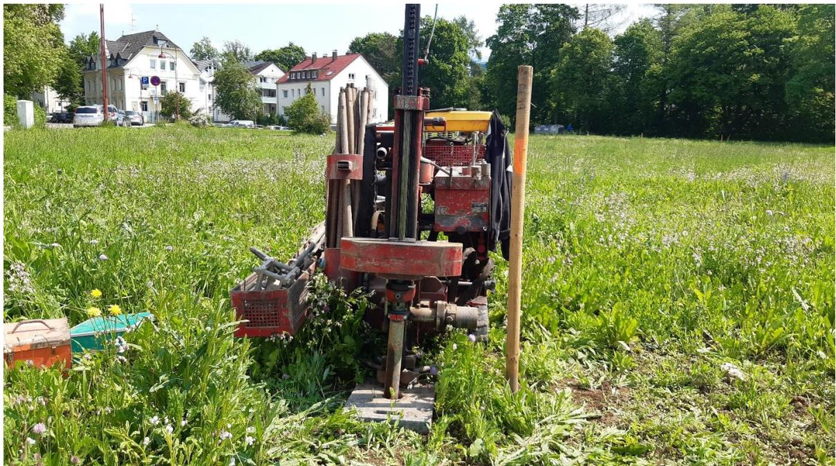
Abbildung 4 Durchführung der Rammkernsondierungen mittels Raupenbohrgerät am 09. und 10.06.2021
