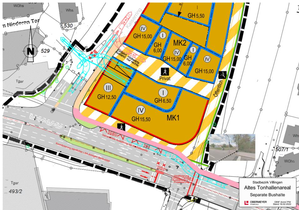
Abbildung 2: Schleppkurvennachweis Anlieferung Edeka /DM (mit Berücksichtigung geplanter Ausbau Bertholdstraße/Kaiserring) und Andienung Amtsgereicht (Gefangenentransport)
